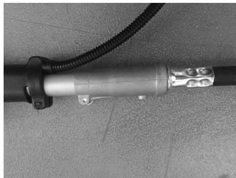
**VORSICHT:** Wenn das flexible Rohr nicht richtig eingesetzt wird, kann es sein, dass das viereckige Ende des Schlauchs nicht richtig in die Dichtung der Antriebswelle passt. Wenden Sie keine Gewalt an, um Schäden an der biegsamen Welle zu vermeiden. Wiederholen Sie den gleichen Vorgang, bis die biegsame Welle und der Schlauch eingestellt sind.
