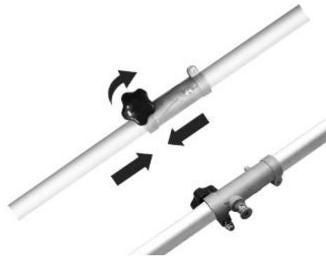
1. Drücken Sie die Entriegelungs-/Sicherungsplatte, um das Gerät zu lösen, und drehen Sie es in die gewünschte Position, je nach Art der auszuführenden Arbeit.
